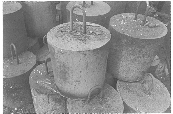
図 4 湯道切断後の铸造品外觀
