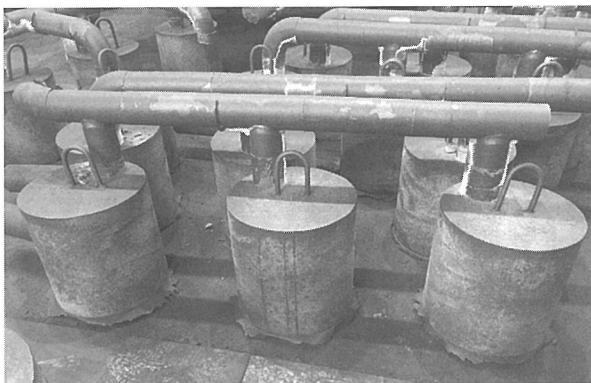
図 3 ショットブラスト後の铸造品外觀
